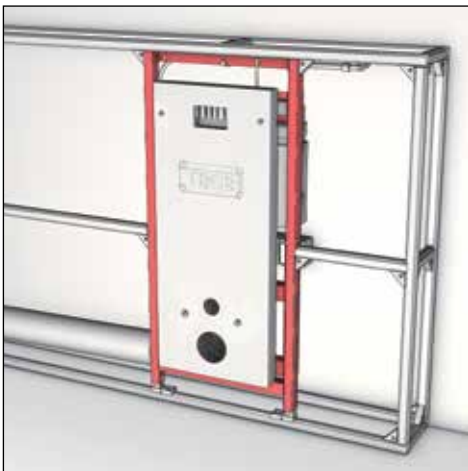
(2) Установка шаблона для отделки отверстия в стене.
