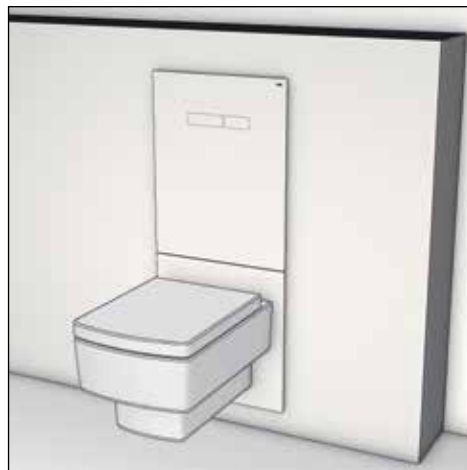
(6) Монтаж верхней стеклянной панели. Сборка завершена.
